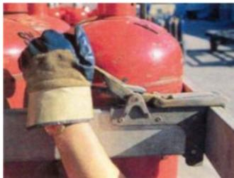
그림 7 - 수평슬랫(Transverse slat)과 신속한 체결장치(Clamping device)
